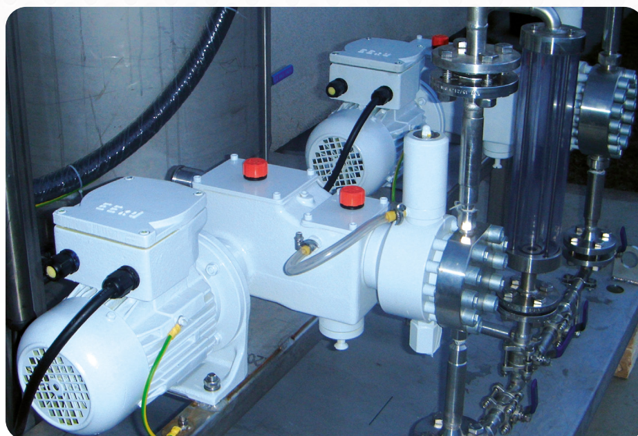
Olajfinomító- inhibitor adagolás
